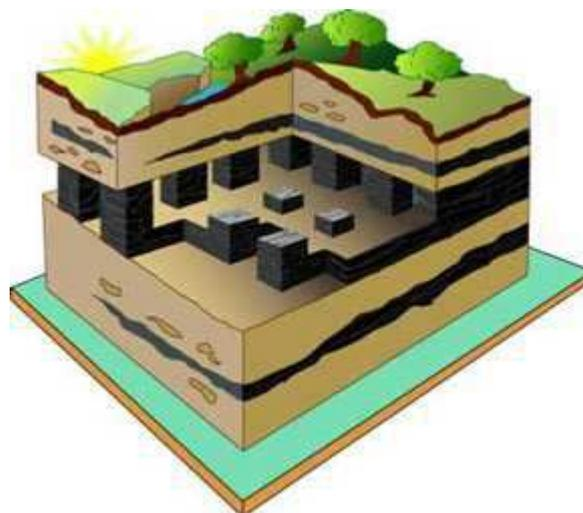
Figure 4 : Schéma du principe d'une exploitation par chambres et piliers abandonnés
